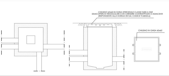
PARTICOLARE POZZETTO 60x120 Scala 1:20
